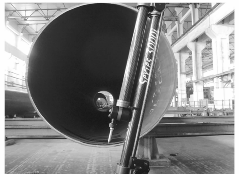
图 8 采用便携式三坐标测量机测量管坯椭圆度
